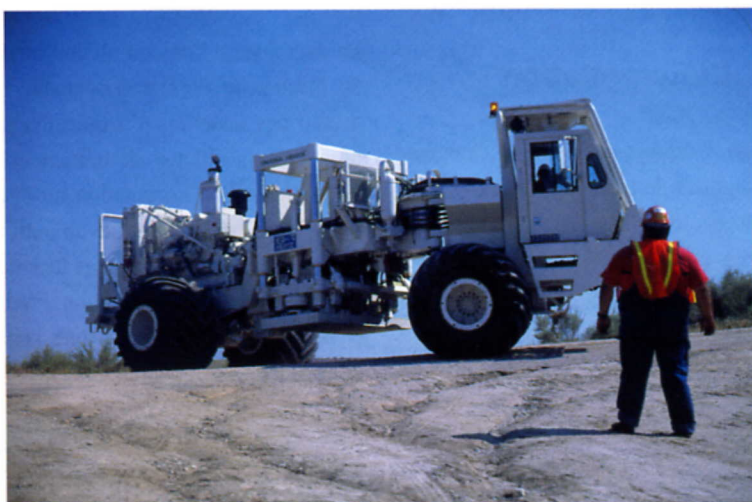
Le vibreur est la source la plus utilisée ; pour augmenter l'énergie émise on opère des groupes de 4 ou 5 vibrant simultanément
