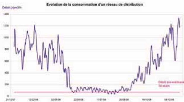
La consommation minimale constatée sur une zone de raccordement fixe le débit maximal d'injection de biométhane
