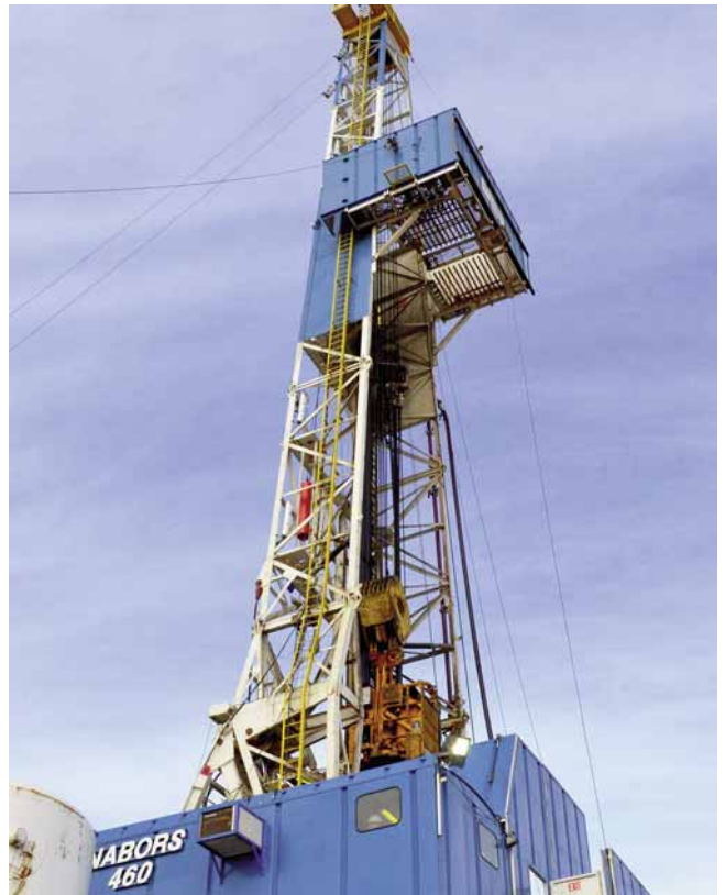
Appareil de forage de puits de gaz de schiste Photo Eva Sleire STATOIL
